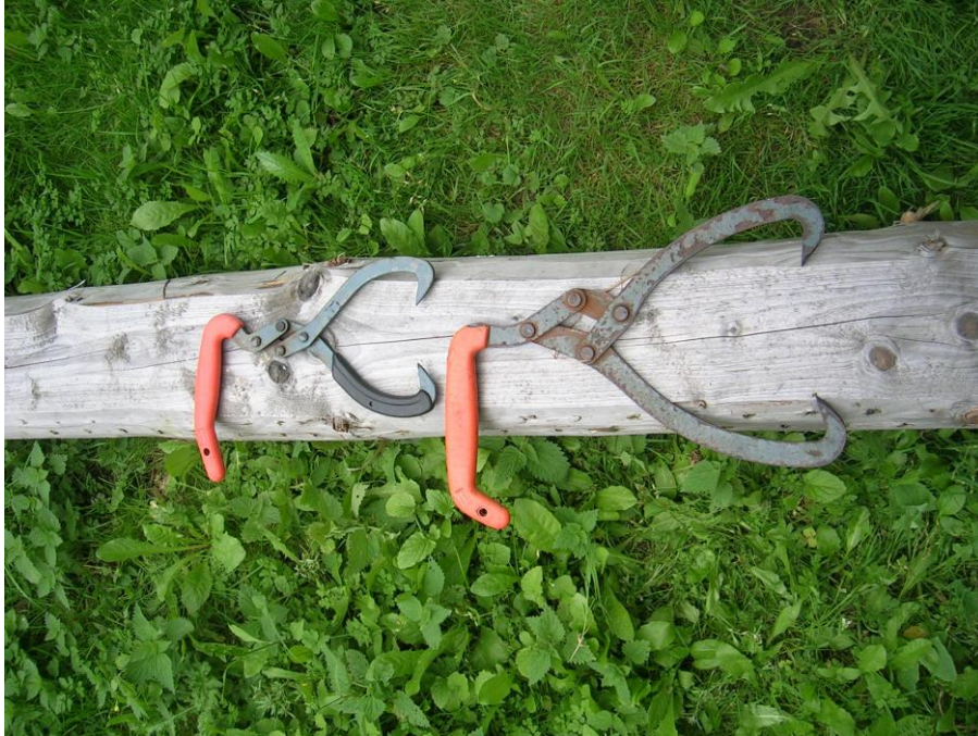
Bæretænger fås som regel i to størrelser. Den lille kan ikke altid gabe over shelterstokkene.
