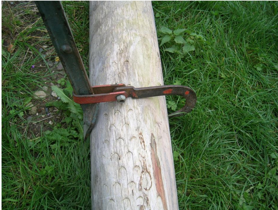
Fældejernets vendekrog giver et stort moment, når tømmer skal roteres.
