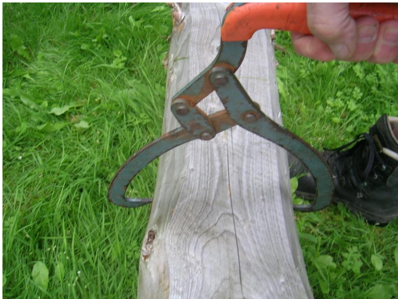
Bæretangen-tømmersaksen låser om tømmeret når man løfter i håndtaget.
